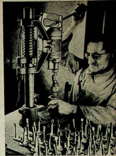
Rechts: Bohren der Schraublöcher für die Antennenhalter
