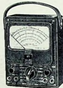
Abb. 2. Vielfachmeßinstrument mit hohem inneren Widerstand (Modell 260 der Simpson El. Comp.)
